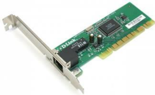
Рис. 6. Сетевая карта в виде платы расширения, устанавливаемой в PCI-слот
