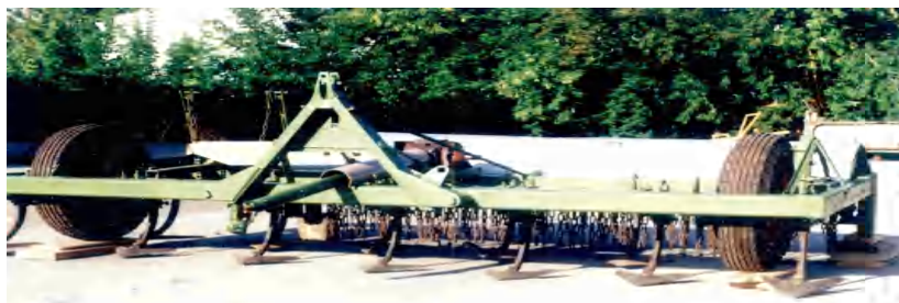
Рис. 1. Комбинированная почвообрабатывающая машина: культиватор для предпосевной обработки почвы (экспериментальная установка)
