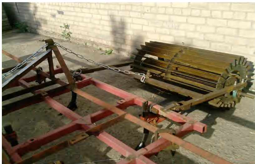
Рис. 2. Культиватор с тросово-катковым рабочим органом (экспериментальная установка)
